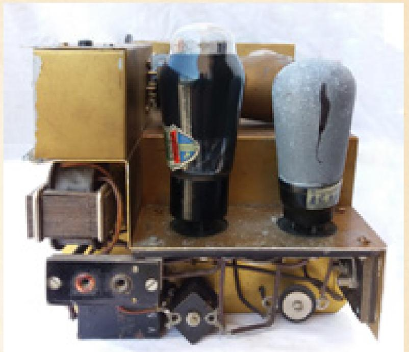
Monta cinque valvole: due Dario I 4091, una Dario V80, una Dario I 4076 ed una Dario R79 e sulla sinistra del telaio, al quale si accede sollevando il coperchio nel caso del mobile
